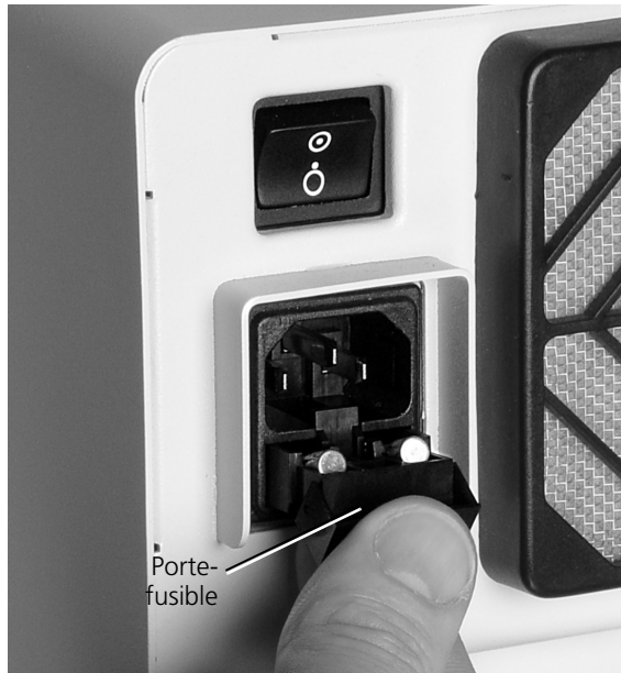
Figure 8-4. Remplacement d'un fusible
