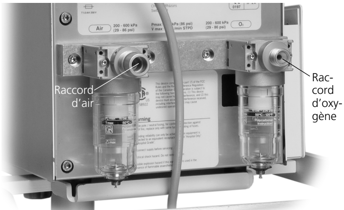
Figure 2-2. Connexion aux arrivées d'air et d'oxygène
