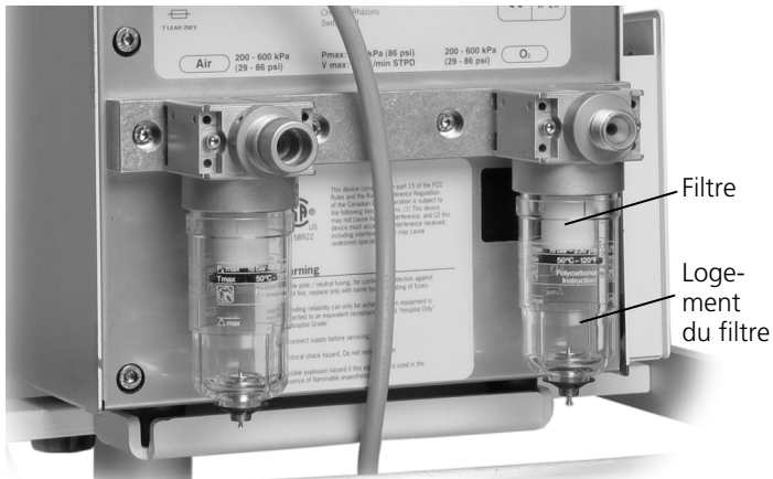
Figure 8-2. Remplacement d'un filtre d'alimentation en gaz
